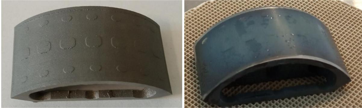
Abb. 7: Metallische Komponente des Funktionsdemonstrators mit Strukturierung für definierten Löt-Spalt, gefertigt mittels LBM aus Ti-35Nb-6Ta beim Projektpartner IAPT (links), aufgefüllt mit Glaslot, geglättet und vorbereitet zur Verlotung mit der Keramikkalotte (rechts)
