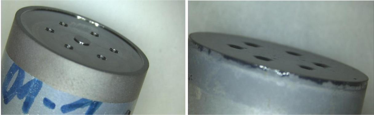
Abb. 5: Löt-Spalt durch Einstich (links) und mit Glaslot gefüllter Spalt (geschliffen, rechts)
