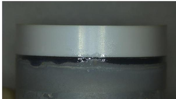
Abb. 6: Volumenfüllend und kraftschlüssig verlötete Haftzugprobe ATZ-Keramik/Reintitan
