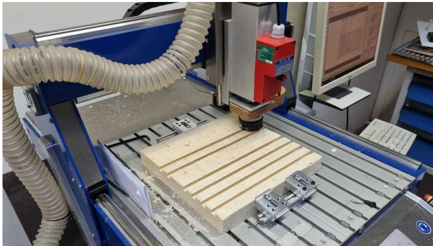
Abbildung 2: Fräsen der Schwalbenschwanz-Nuten in einer CNC-Fräsmaschine
