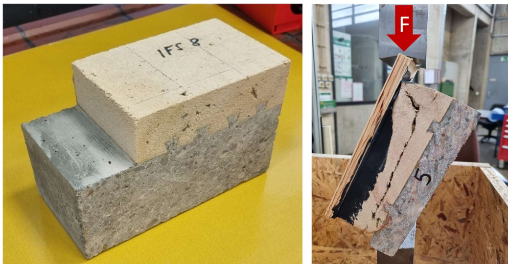
Abbildung 4: Links: Zugeschnittener Holzschaum-Beton-Verbund, rechts: Schubdruckprobe in Prüfmaschine
