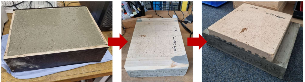
Abbildung 3: Aushärten des Betons in der Gussform, Ausschalen und entfernen der Kanthölzer
