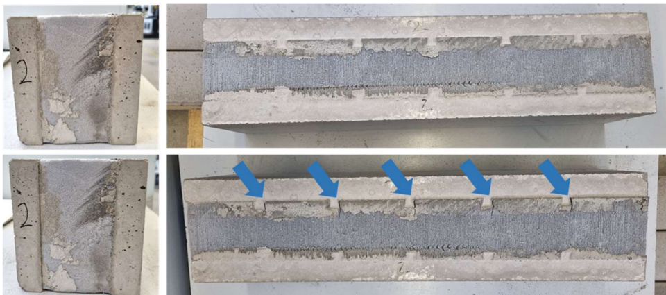
Abbildung 19: Typisches Bruchbild der Balkenproben mit Styrodur® anhand einer exemplarischen Probe. Oben vor Prüfung, unten nach Prüfung. Die blauen Pfeile deuten auf Risse an den Flanken der Schwalbenschwanz-Nuten.
