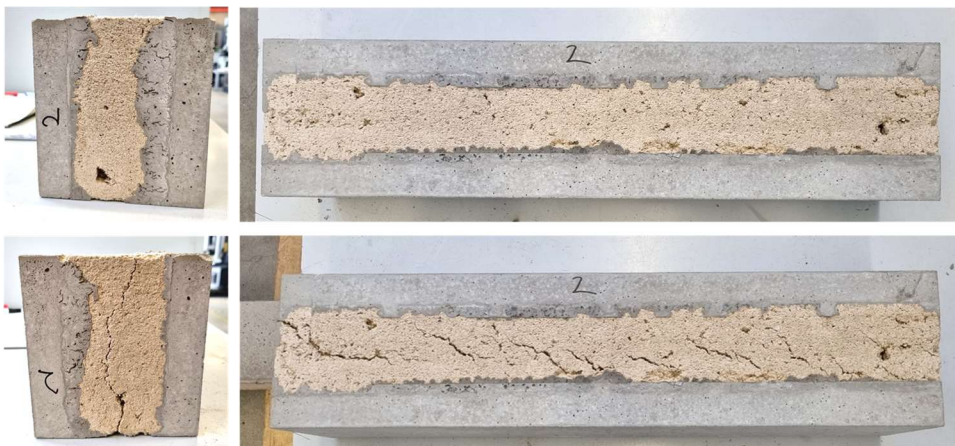
Abbildung 18: Typisches Bruchbild der Balkenproben mit Holzschaum anhand einer exemplarischen Probe. Oben vor Prüfung, unten nach Prüfung.
