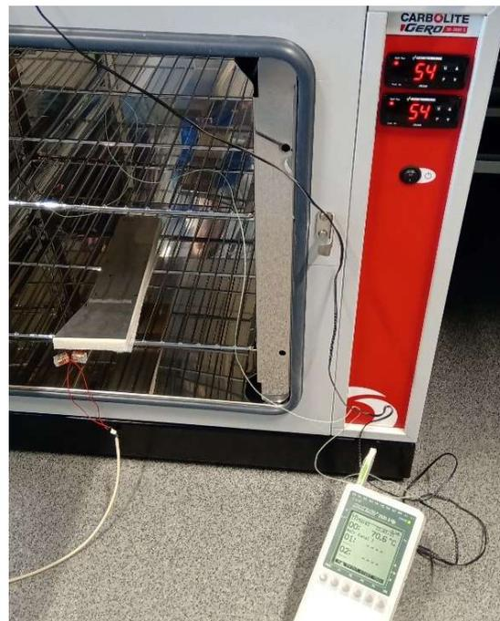
Abbildung 18: Probe im Umluftofen
